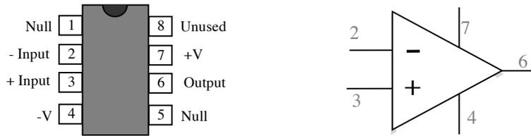
**Figure 3:** Pin layout for 741 IC op amp.
